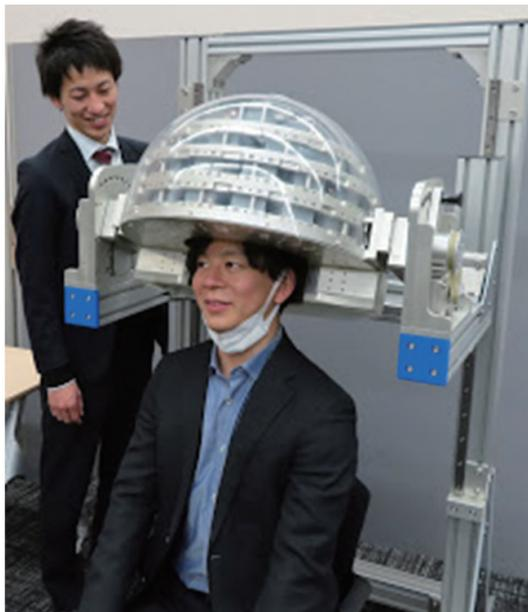
図10 ヘルメット型PET試作機
